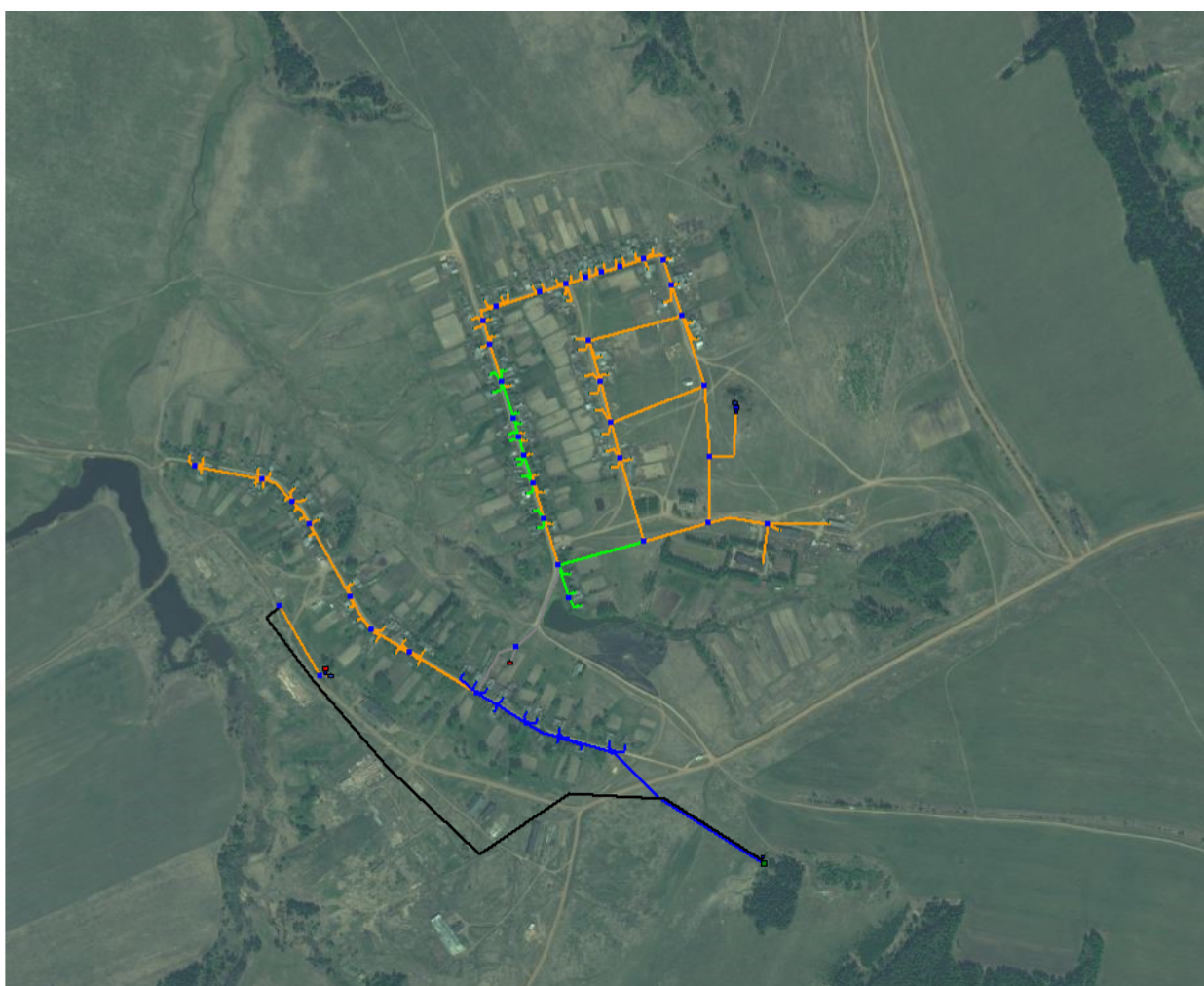
Рисунок 8 – Распределение давления в водопроводной сети д. Зюино
